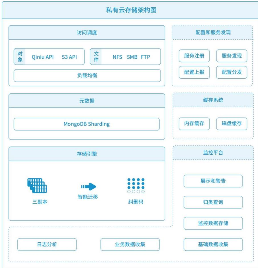
图 3-1 七牛私有云存储系统架构
